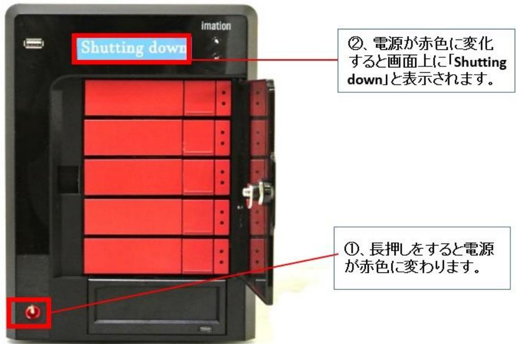
※再起動する際は、1 で記載している電源部分を押しして下さい。
